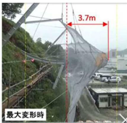
実物大実験の防護網の変形状況
